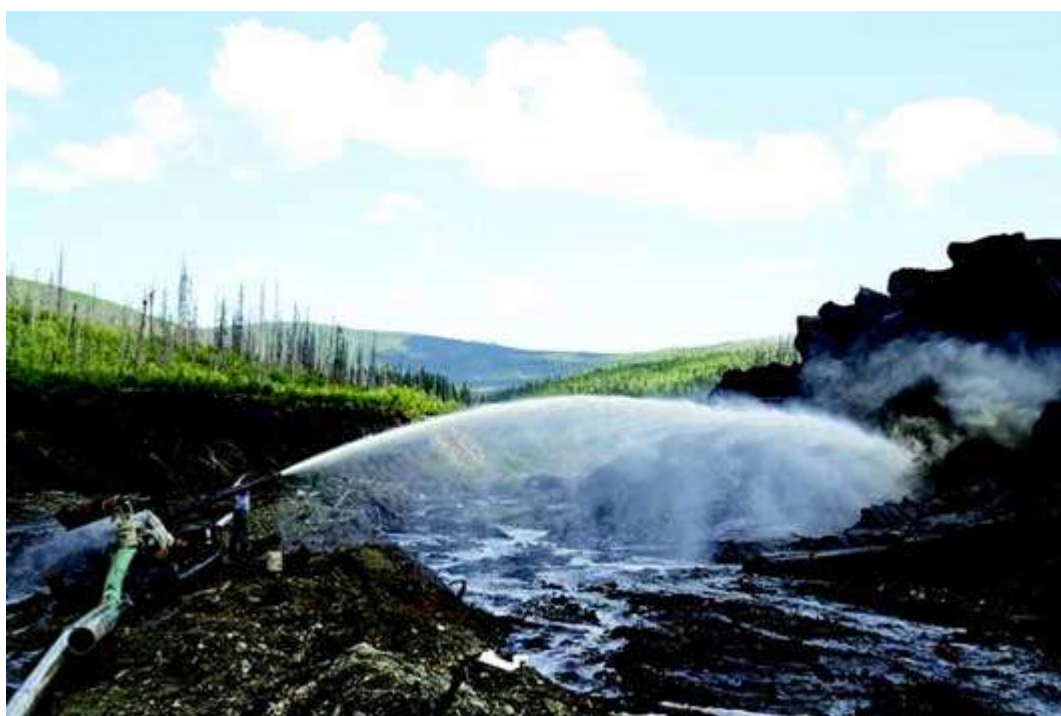
Иллюстрация 6. Разработка россыпи около города Доусон, территория Юкон, Канада. Золотодобытчики выливают на замерзшую почву воду под большим давлением, чтобы открыть лежащую под ней золотоносную россыпь. После того как слой почвы смывается, на поверхность выходят кости, зубы, бивни и другие останки, которые теперь можно собирать. Фотография предоставлена Тайлером Куном и Матиасом Стиллером
